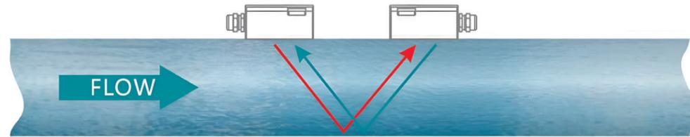
Un misuratore a ultrasuoni dotato di capacità di flusso di calore, misura la portata e la quantità di calore erogato o rimosso da dispositivi come gli scambiatori di calore. Misurando la portata volumetrica del liquido dello scambiatore di calore, la temperatura nel tubo di ingresso e la temperatura nel tubo di uscita, è possibile calcolare l'utilizzo di energia.
